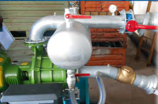
Collo di cigno fisso con valvola a farfalla e curva a 90° Col de cygne fixe avec vanne papillon et courbe à 90° Cuello de cisne fijo con valvula mariposa y curva a 90°
